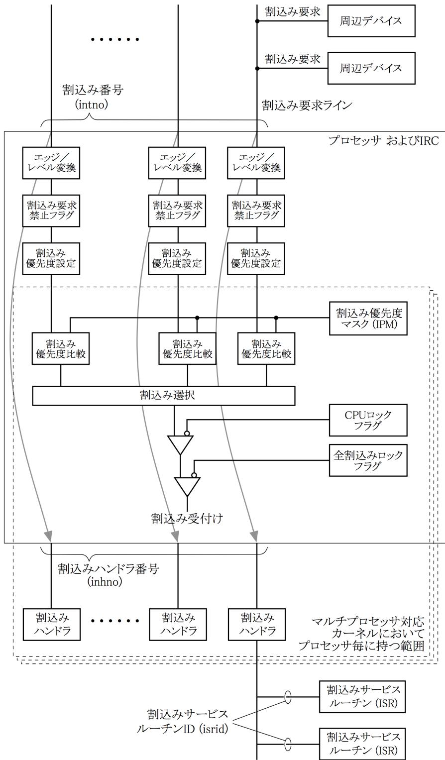
図2-6. TOPPERS標準割込み処理モデルの概念図
