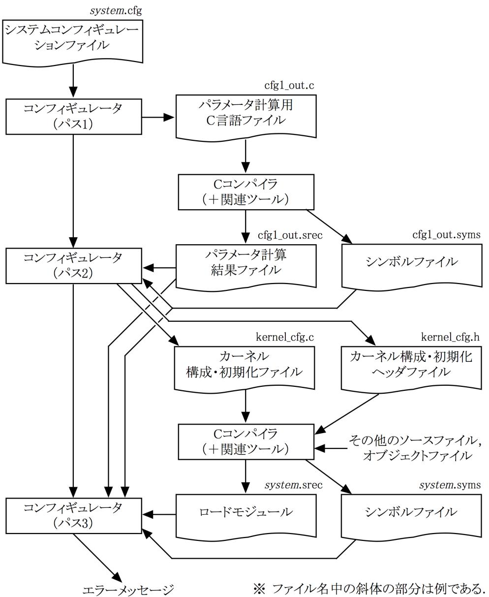
図2-10. コンフィギュレータの処理モデル
