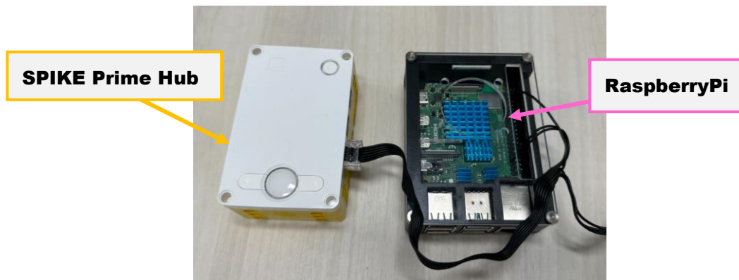
図 1. Hub(左)と RaspberryPi (右). 両者は UART で接続されている。
