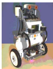
2010 走行体にくらべ 走行体後部に直立用モータ が追加され、Bluetooth 通 信により、遠隔スタートが 可能となった。
