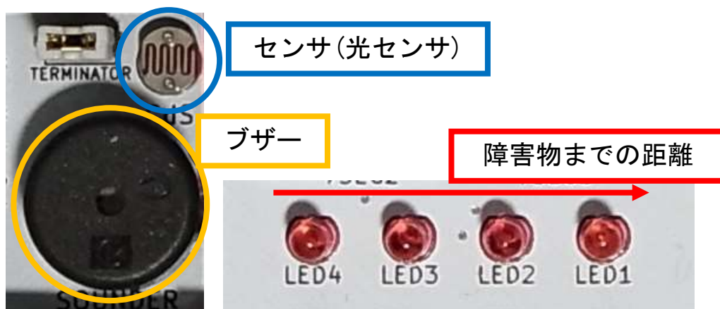
図 4 衝突検知センサの模擬
