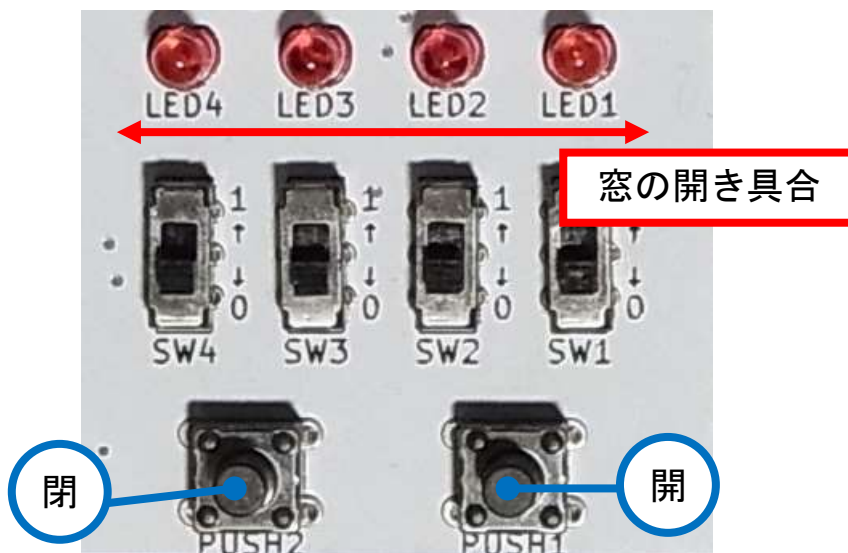
図 3 パワーウィンドウコントローラの模擬
